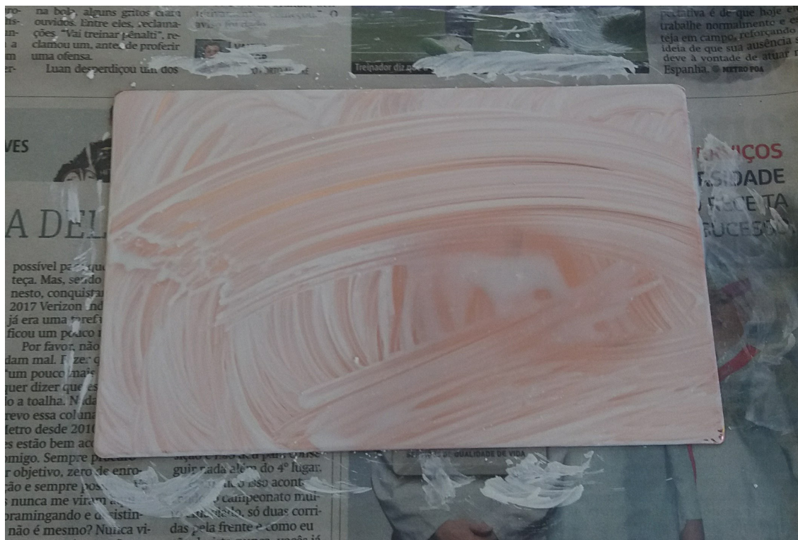
Preparação da chapa - desengordurando com carbonato de cálcio e álcool
